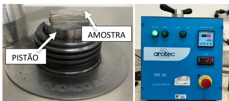
FIGURA 5. Amostra sobre o pistão, prensa embutidora automática. Fonte: Os autores (2022).
