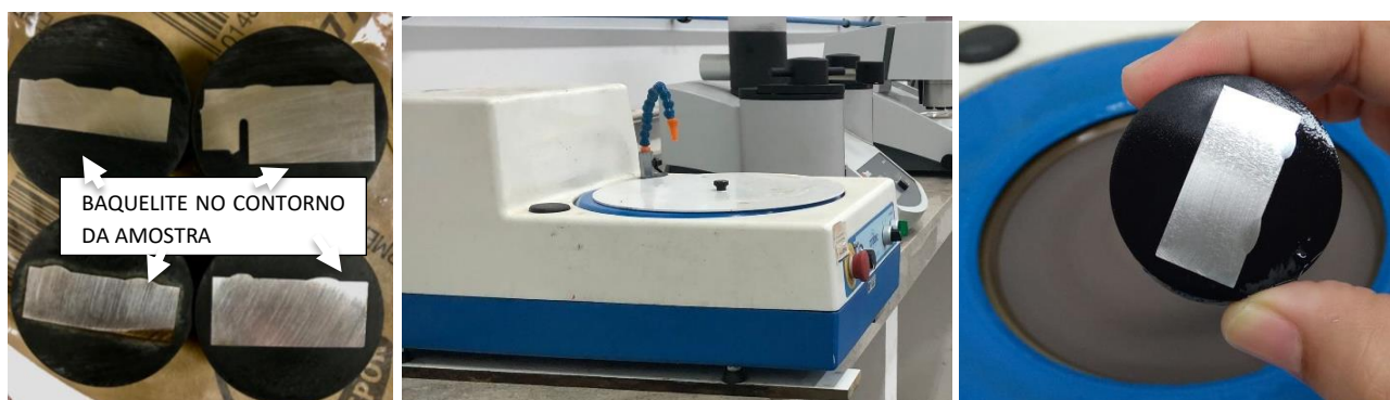
FIGURA 6. Amostras soldadas embutidas, Politriz, Amostra lixada. Fonte: Os autores (2022).
