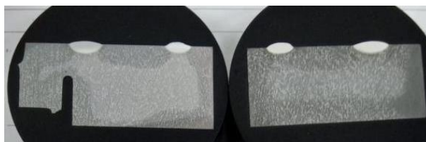
FIGURA 8. Amostras atacadas por 5 segundos. Fonte: Os Autores (2022).
