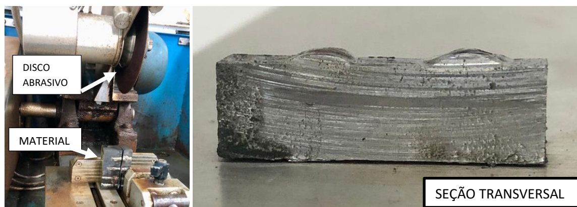
FIGURA 4. Utilização da policorte para obtenção das amostras, seção de corte. Fonte: Os autores (2022).
