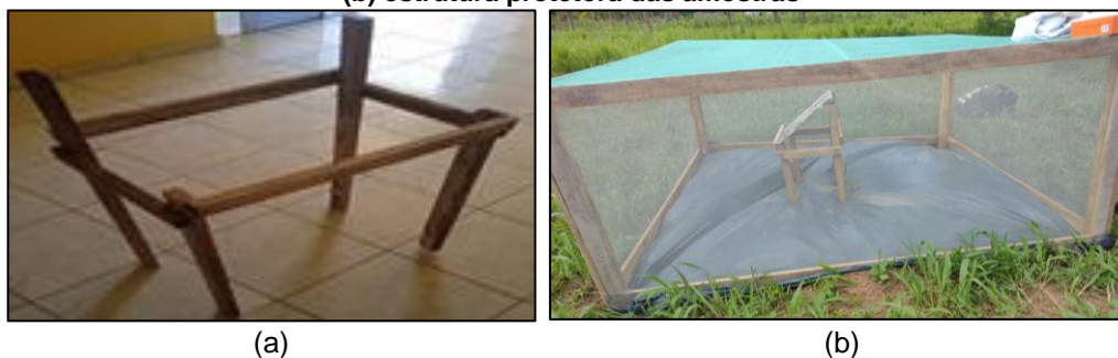
Figura 1 – Ilustração da montagem do sistema de suporte para a telhas sendo (a) suporte da amostra de telha e (b) estrutura protetora das amostras
