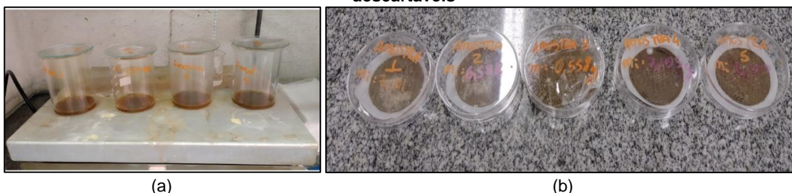
Figura 2 – (a) amostras em digestão ácida em chapa aquecedora; (b) amostras em seus porta-amostras descartáveis
