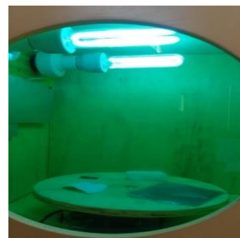
Figura 2: Imagem da parte interna da cabine de radiação UV desenvolvida, mostrando a disposição das lâmpadas. Fonte: elaborada pelos autores.
