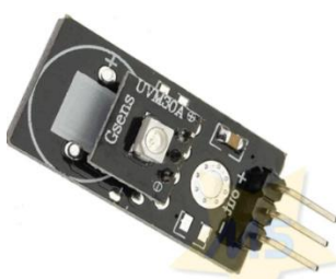
Figura 3: Sensor de Raio Ultravioleta UV UVM-30A utilizado no experimento. Fonte: MarinoStore, acessível em https://www.marinostore.com/ .
