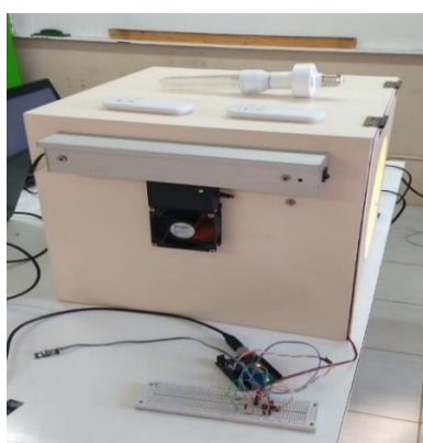
Figura 5: Visão da ligação da placa Arduino que conecta o sensor de radiação UV dentro da cabine com o computador externo para a leitura dos dados. Fonte: elaborada pelos autores.
