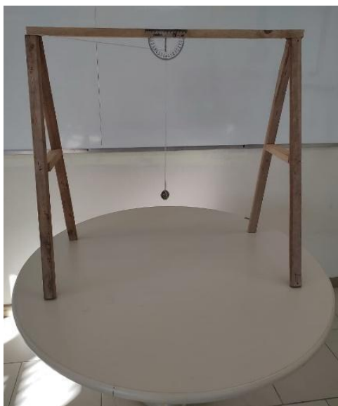
Figura 1 - Aparato experimental utilizado no experimento do pêndulo simples.
