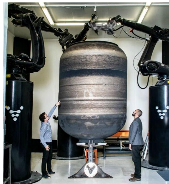
Figura 1. Tanque de combustível em alumínio para o foguete Terran I (Relativity Space apud ARS TECHNICA, 2019).
