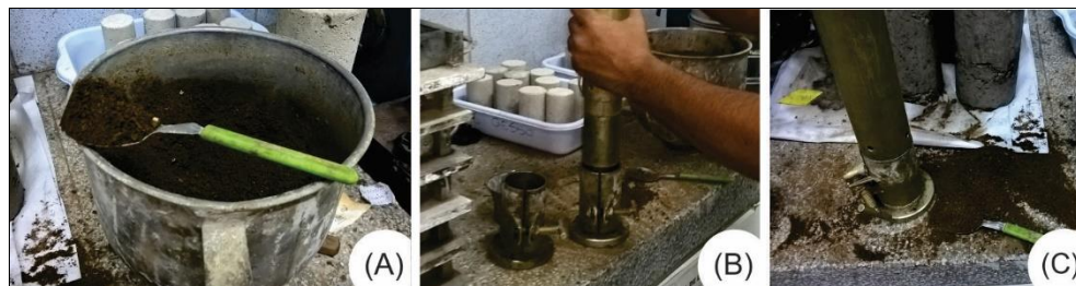
Figura 2 - (A) colher utilizada para cada camada; (B) diâmetro interno soquete coincide com o diâmetro do CP e (C) soquete encaixado no CP.
