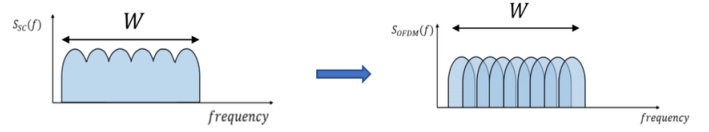
Figura 1: Banda ocupada com portadora única versus ocupada por subportadoras. Adaptado de [3].
