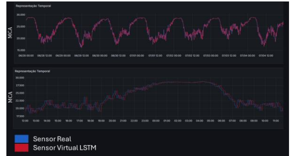
Figura 3. Apresentação dos dados do sensor real e do sensor virtual na plataforma Grafana.
