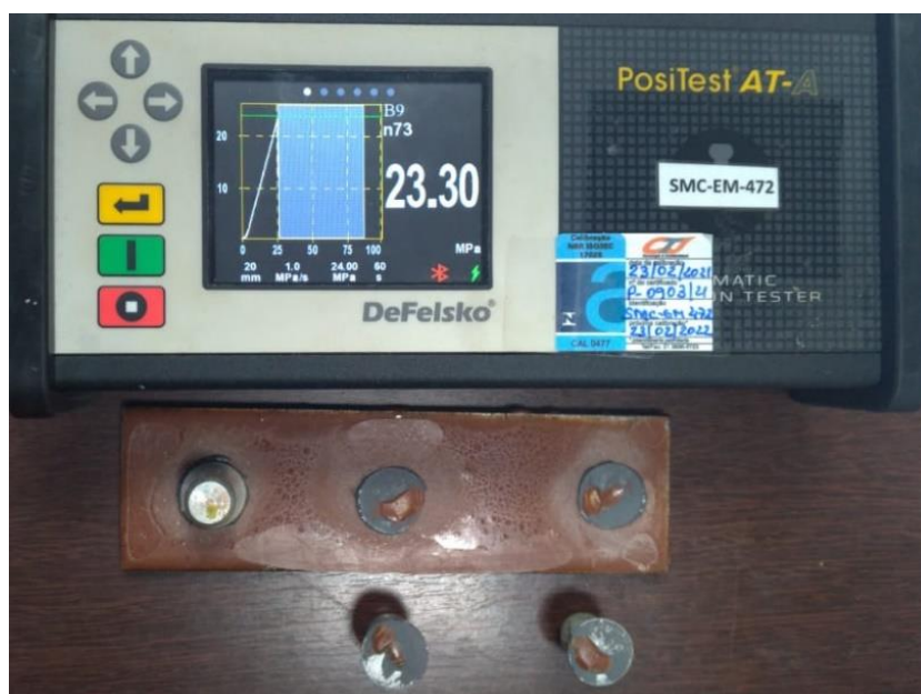
FIGURA 8. Apresentação do resultado obtido por meio do ensaio de adesão por arrancamento.
