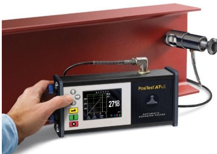
FIGURA 5. Aparelho de pull off . Fonte: Blastingexperts (2021).
