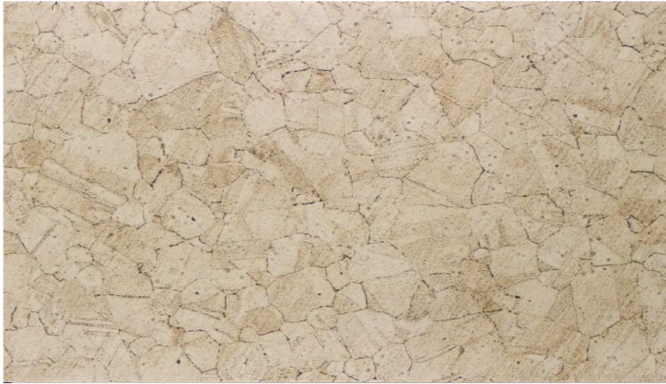
Figura 5: Imagem extraída de capturada por Palácio (2008); Aspecto microestrutural para AISI 304 submetido a tratamento térmico para precipitação e carbonetos de cromo. MO, ataque químico Vilella.
