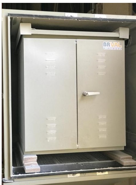
FIGURA 1. Protótipo na câmara de ensaio grau de proteção IP5X. Fonte: Autores (2020).
