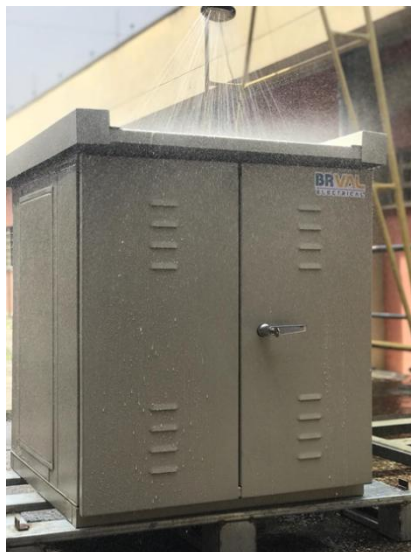
FIGURA 2. Protótipo na câmara de ensaio grau de proteção IPX4. Fonte: Autores (2020).
