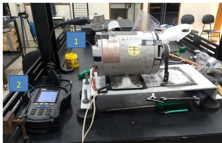
FIGURA 1. Bancada de testes onde foram testados os rolamentos. Fonte: Autor (2019).
