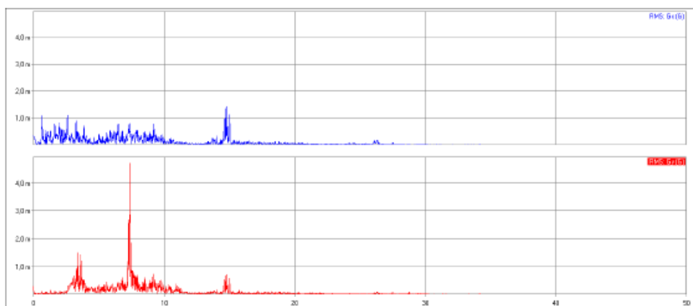
FIGURA 18. Gráficos do espectro de frequências naturais para as direções Gx e Gy do acelerômetro 01 instalado na viga principal. Frequência natural próxima de 8,0 Hz na direção Gy com alto nível de excitação. Fonte: Autor (2018).
