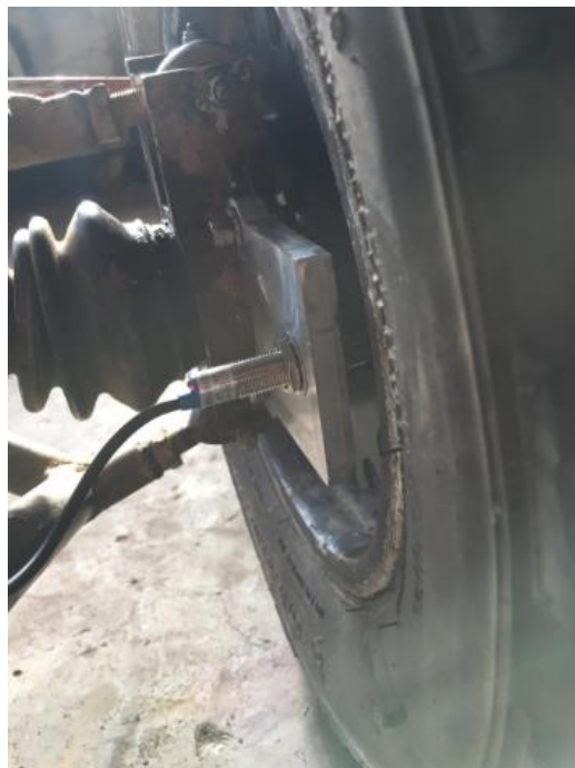
FIGURA 2. Posicionamento do sensor. Fonte: Arquivos da equipe Komiketo Baja UFSJ (2019).
