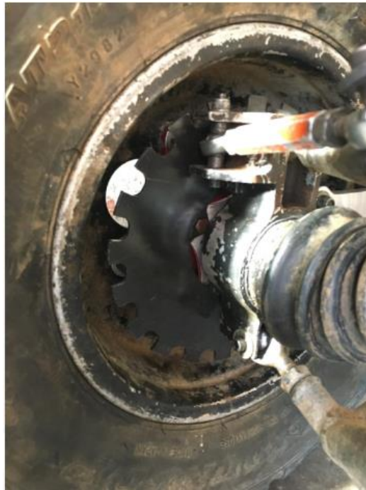
FIGURA 1. Posicionamento da roda fônica. Fonte: Arquivos da equipe Komiketo Baja UFSJ (2019).
