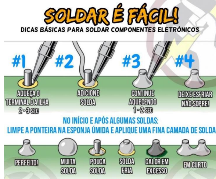
Figura 10 – Tutorial de soldagem de componentes eletrônicos.
