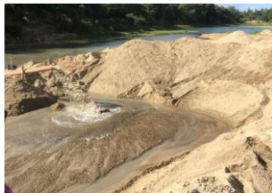
Figura 16: Extração por bombeamento e contendo a água.
