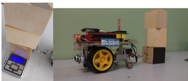
Figura 12. A figura mostra vários blocos lisos idênticos com objetivo de verificar se existe alterações no valor de \mu quando há um acréscimo de massa.
