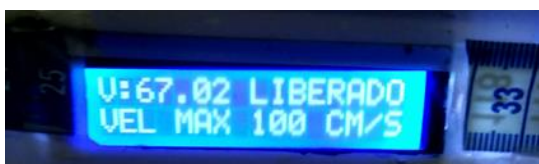
Figura 7. LCD da régua mostrando a velocidade permitida da via ( 100cm/s). Como o Módulo passa com 67,02cm/s ele foi liberado.
