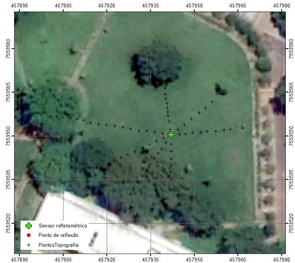
Figura 5. Levantamento topográfico de validação.
