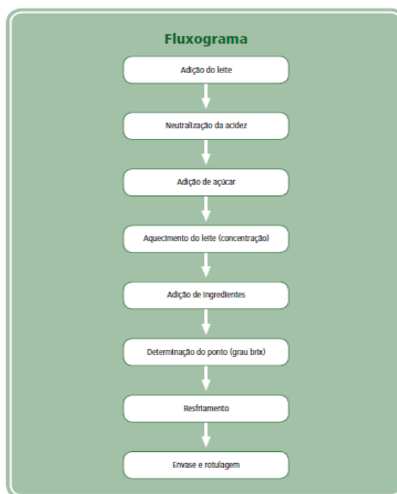
Figura 01. Fluxograma da elaboração do Doce de Leite Tradicional Segundo Gilvan 2012. síntese e considerações, devem ser claras e apresentadas de acordo com os objetivos propostos no trabalho
