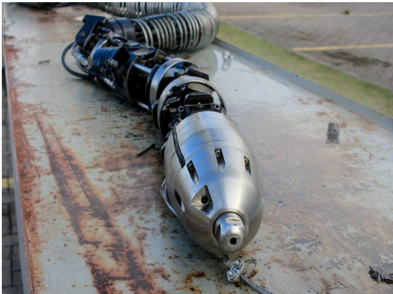
Figura 2 - Robô annelida utilizado para a desobstrução de dutos flexíveis em águas profundas.
