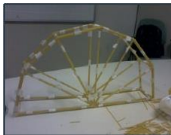
FIGURA. 1: FASE DE UNIÃO DAS LATERAIS DAS TRELIÇAS.
