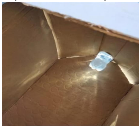
Figura 3 – Observação do efeito luminoso produzido pela lâmpada de Moser no interior da maquete
