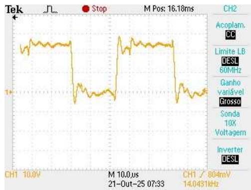
Figura 6. Sinal medido da saída do inversor comercial. Fonte: Autor, 2026.
