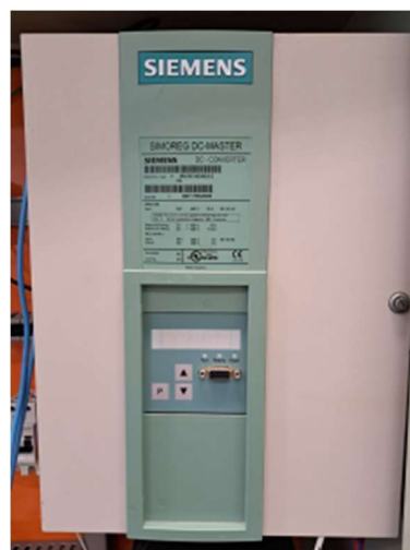
Figura 4. Conversor SIMOREG DC-MASTER utilizado nos ensaios experimentais, destacando a interface de entrada analógica empregada para o controle da velocidade da máquina de corrente contínua. Fonte: Autor, 2026.
