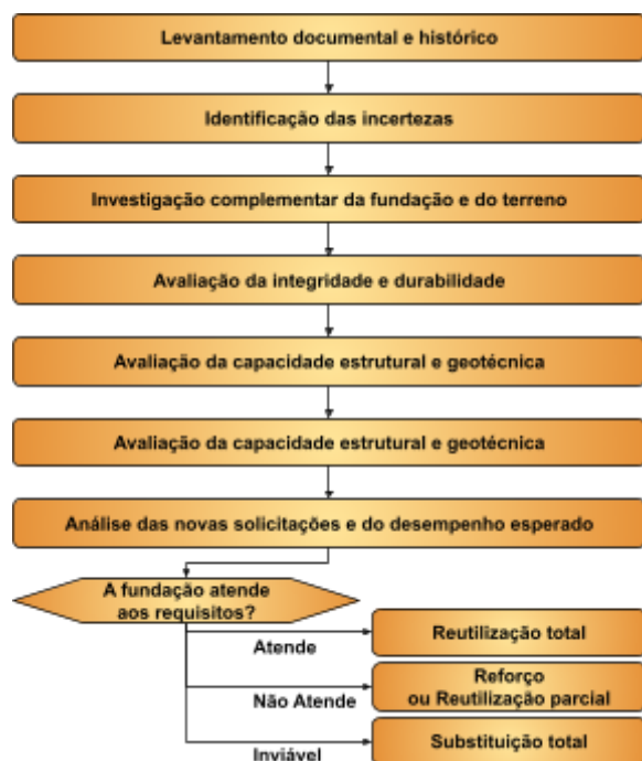
Figura 5. Fluxograma proposto para avaliação da possibilidade de reutilização de fundações existentes.
