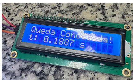
Figura 2. Exibição automatizada do tempo de queda livre da esfera no display LCD 16x2 após o processamento dos sinais das bobinas.
