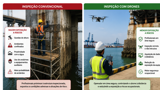
Figura 4. Comparação entre inspeções convencionais e inspeções realizadas por drones quanto à exposição dos profissionais aos riscos ocupacionais.
