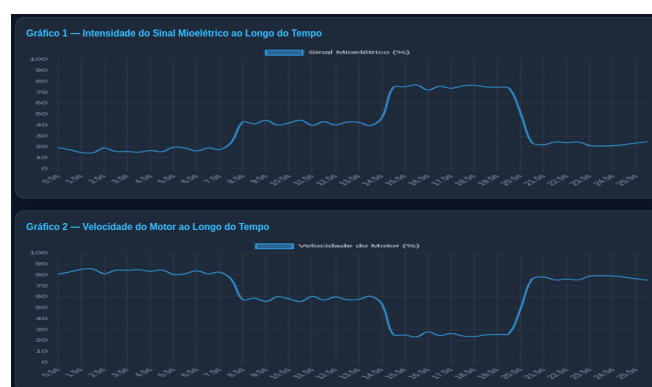
Figura 3: intensidade do sinal mioelétrico (superior) e velocidade do motor elétrico (inferior).
