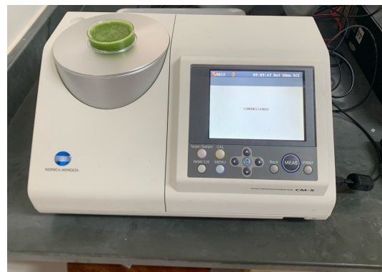
Figura 2. Análise colorimétrica do gel de palma forrageira em espectrofotômetro.
