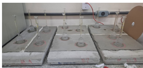
Figura 5. Placas de revestimento argamassado preparadas para a realização do ensaio de permeabilidade à água sob baixa pressão.
