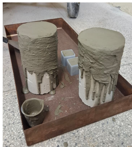
Figura 1. Aplicação das argamassas poliméricas nos corpos de prova (10x20) cm.
