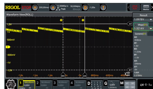
Figura 8: Oscilação observada para referência de 1,5 V.
