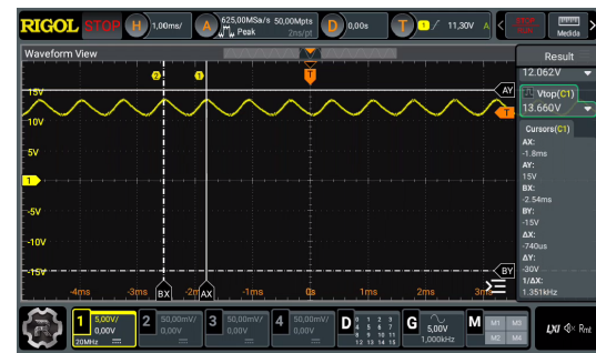
Figura 7: Oscilação de baixa frequência observada em aproximadamente 12 V e 47 \Omega .
