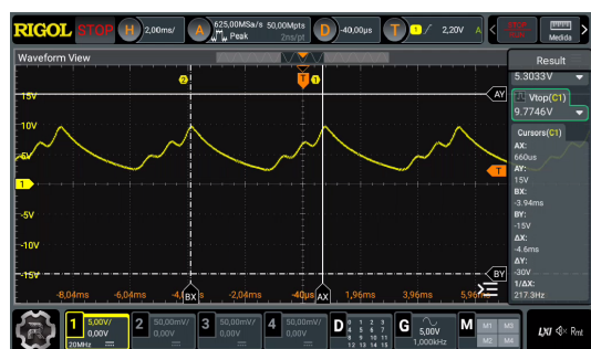
Figura 9: Tensão de saída durante a atuação do algoritmo de limitação de corrente.
