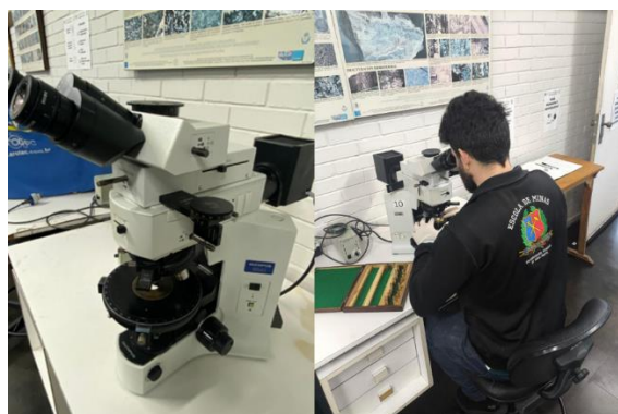
Figura 5. Microscópio petrográfico de luz refletida e transmitida do Laboratório de Microscopia Óptica, DEGEO, EM, UFOP.
