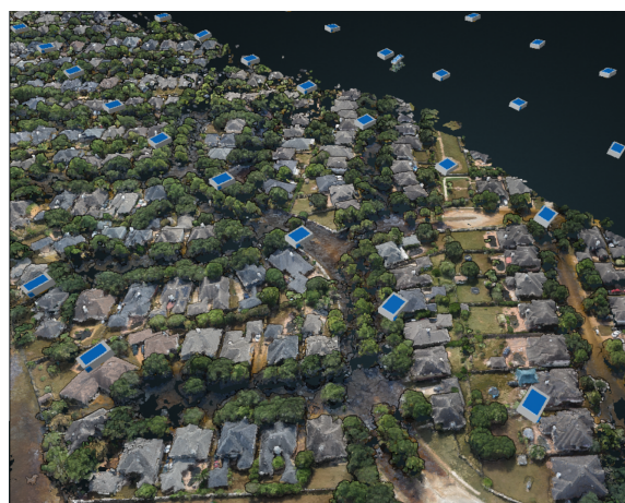
Figura 6. Nuvem de pontos reconstruída pelo WebODM com posição relativa das imagens.
