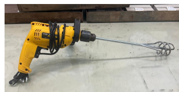
Figura 1. Misturador utilizado para o preparo das argamassas
