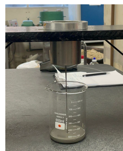
Figura 6. Ensaio com cilindro espanhol (a) Cilindro espanhol; (b) realização do ensaio.
