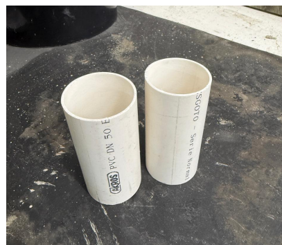
Figura 2. Cilindros de PVC utilizados para os ensaios de fluidez e tempo de espalhamento sobre diferentes superfícies
