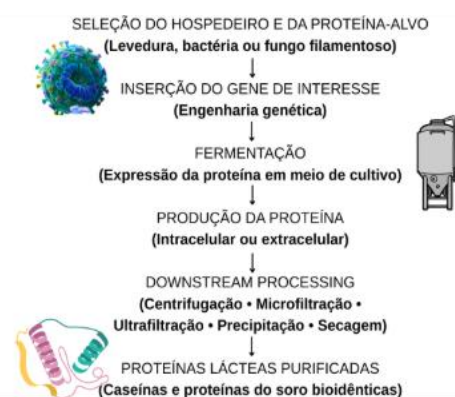
Figura 1. Fluxograma simplificado da produção de proteínas lácteas por fermentação de precisão. Adaptado pelas autoras, 2026.
