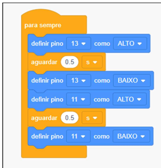
Figura 1. Código em blocos da sirene no Tinkercad.
