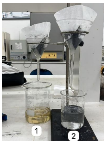
Figura 7. Comparação entre a água de lavagem dos carvões ativados: (1) água residual escura do carvão ativado com KOH, (2) água límpida da lavagem do carvão ativado com H_3PO_4 .
