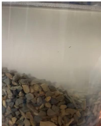
Figura 3. Amostra de filito submersa em água para o ensaio de solubilização
