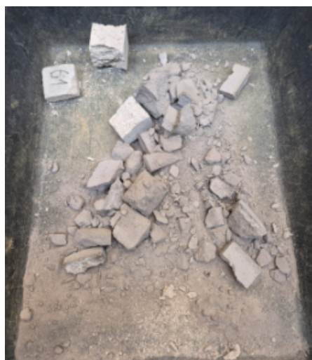
Figura 3. Aspecto dos corpos de prova após ensaio de atividade pozolânica.
