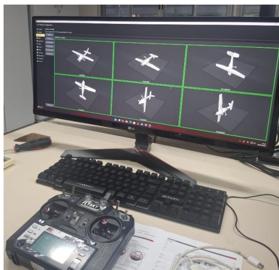
Figura 2. Calibração de sensores QGroundControl e sincronização ativa via rádio.
