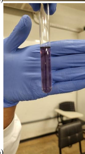
Figura 6. Fotografia do (a) precipitado de \text{Fe}(\text{OH})_3 solubilizado com \text{HCl} ; e (b) reação química de complexação, usada para identificação dos íons \text{Fe}^{3+} na amostra.
