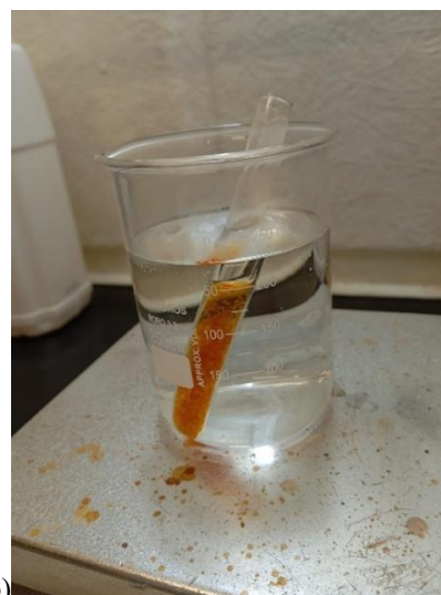
Figura 2. (a) Formação do precipitado gelatinoso de cor marrom-avermelhada; (b) mistura reacional em banho-maria.
