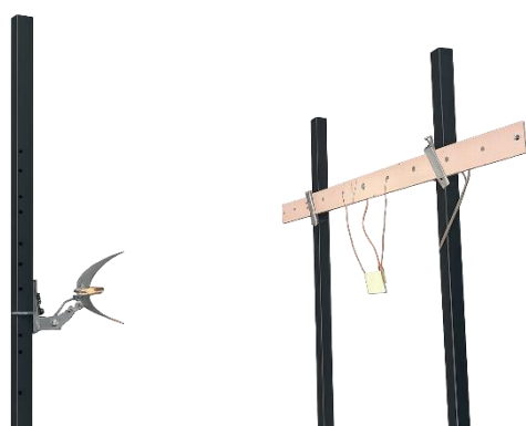
Figura 7. Montagem experimental do ensaio de caracterização da lâmpada infravermelha com chapa de ABS.
