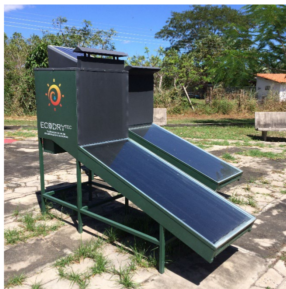
Figura 1. Desidratador solar termofotovoltaico 216GII desenvolvido na UFPI.
