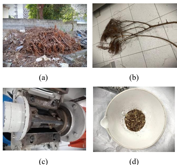
Figura 4. Obtenção e preparo da biomassa residual de Pinus utilizada nos ensaios: (a) resíduo vegetal de Pinus no campus Higienópolis da UPM; (b) amostra selecionada para processamento; (c) equipamento utilizado para trituração da biomassa; (d) biomassa residual seca e triturada empregada na EAU.
