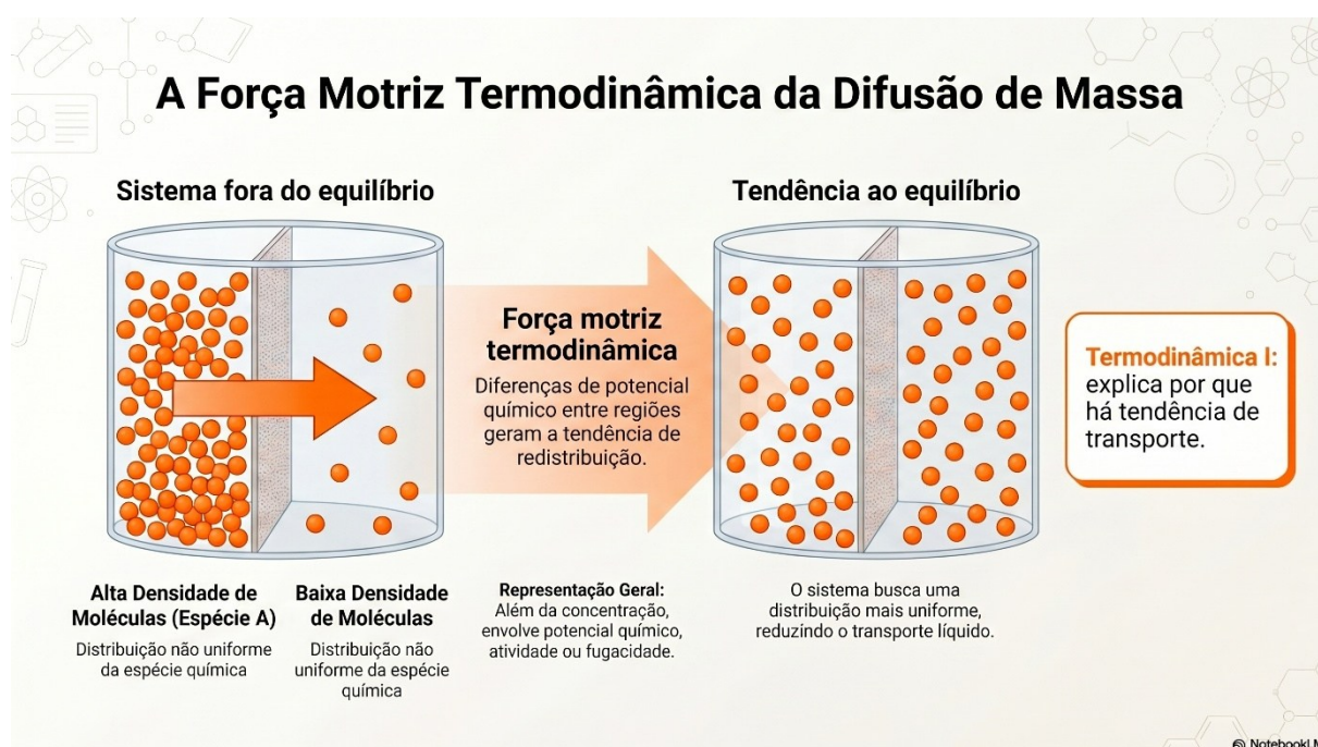
Figura 2. Representação visual da força motriz termodinâmica da difusão de massa, destacando a tendência de redistribuição da espécie química em direção a uma condição mais próxima do equilíbrio.
