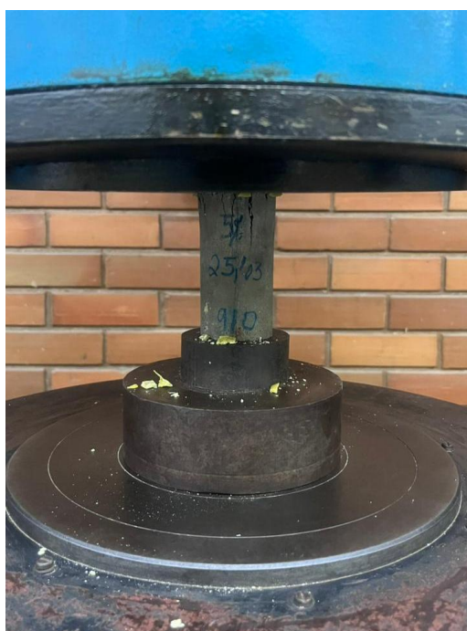
Figura 4. Rompimento do corpo de prova
