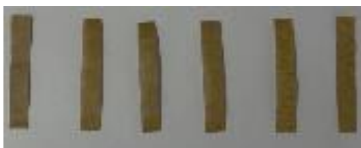
Figura 1 – Filamentos de amostras de papel kraft isolante termoestabilizado dos seis lotes na condição pré-secagem.
