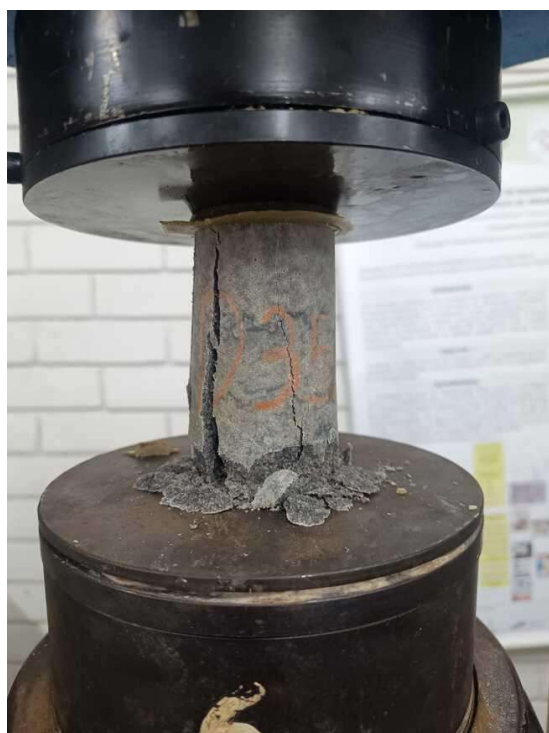
Figura 4. Rompimento de corpo de prova de cimento CP V-ARI com 364 dias
