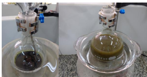
Figura 1. Aspecto do sistema durante a oxidação química do grafite e após a adição de peróxido de hidrogênio.
