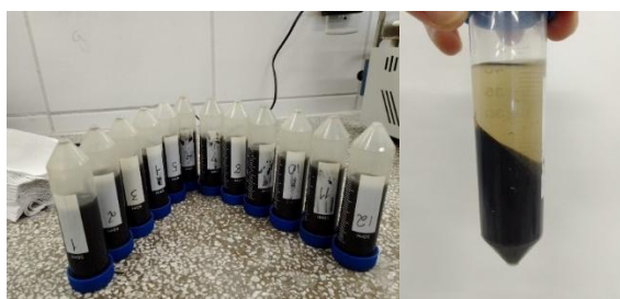
Figura 2. Etapas de lavagem e centrifugação do material oxidado obtido após a síntese.
