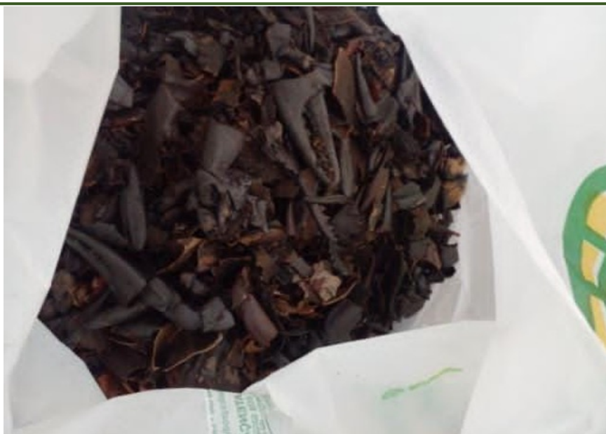
Figura 2 - Biocarvão das carapaças de siri, obtido a 450 °C como produto do processo de pirólise
