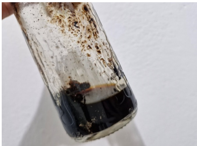
Figura 3 - Bio-óleo das carapaças de siri, obtido a 450 °C como subproduto do processo de pirólise.
