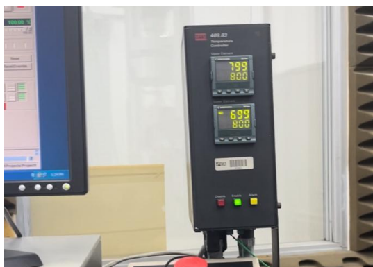
Figura 3. Controlador de temperatura utilizado para o monitoramento e ajuste da temperatura durante os ensaios de compressão a quente.
