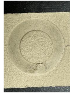
Figura 13 – Alumina após o ensaio com deformação significativa
