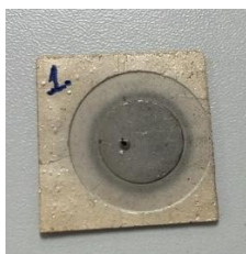
Figura 19. Amostra após o ensaio de vedação a 600 °C, realizado em conjunto com o ensaio de compressão. A coloração escura observada na superfície é proveniente de resíduos oriundos das tubulações do sistema experimental e não corresponde a alterações na composição da amostra.
