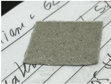
Figura 11 – Papel de mica flexível pós a compressão
