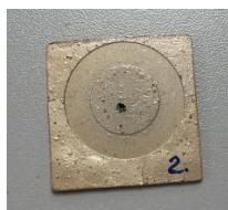
Figura 18. Amostra da alumina após a compressão
