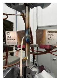
Figura 25. Célula montada no sistema de compressão a 800°C
