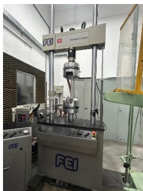
Figura 2. Sistema de teste de vedação – MTS 810 Material Test System
