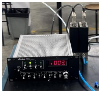
Figura 6. Controlador de vazão mássica ( Mass Flow Controller – MFC ) utilizado para o ajuste e controle do fluxo dos gases alimentados ao sistema.
