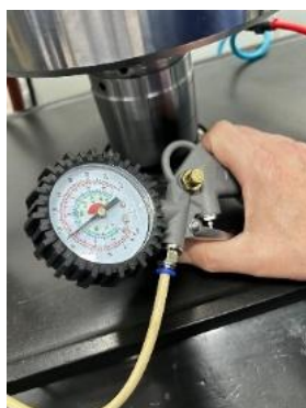
Figura 8 – Sistema de controle de pressão.
