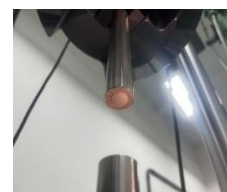
Figura 16 - Parte da amostra de alumina que permaneceu aderida à punção do equipamento de compressão após a fratura do material durante o ensaio.
